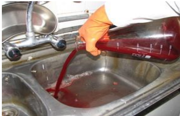
شکل ۱-ج: سیستم شستشو به روش سنتی که محلول شستشو وارد فاضلاب می‌شود.
