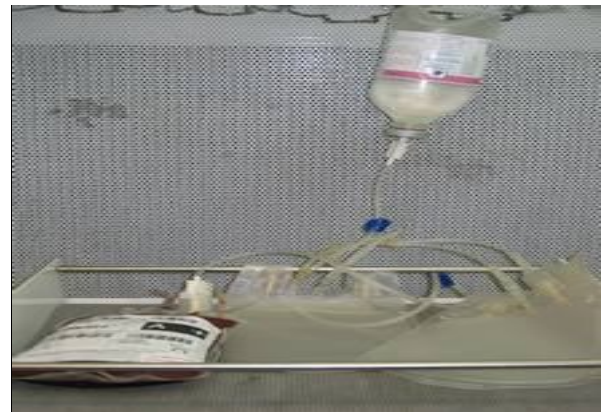
شکل ۲-۲b: سیستم شستشو به روش جدید که محلول شستشو وارد کیسه خون می‌شود.
