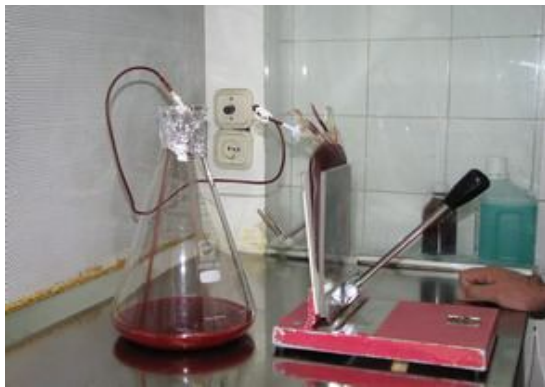
شکل ۱-ب: سیستم شستشو به روش سنتی که محلول شستشو پس از سانتریفوژ وارد ظرف باز می‌شود.
